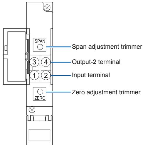
Terminal Arrangement of DG1 and DD1
