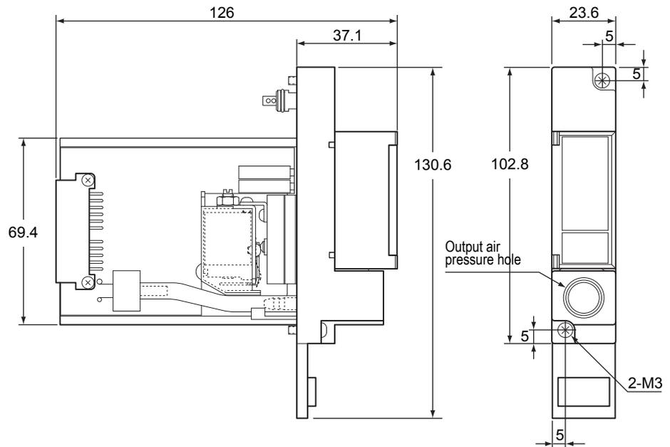
**DF1 Pneumatic to Electric Converter**
