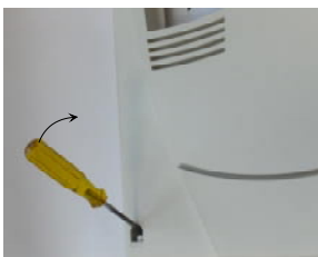
Retire el panel de control del DCS800 si está colocado. Libere los bloqueos para retirar la cubierta
