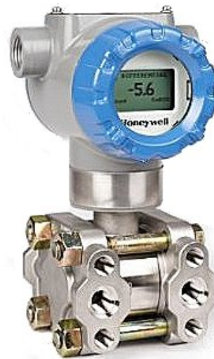
Рисунок 1. В датчиках перепада давления STD800 применяется проверенный на практике пьезорезистивный измерительный элемент
