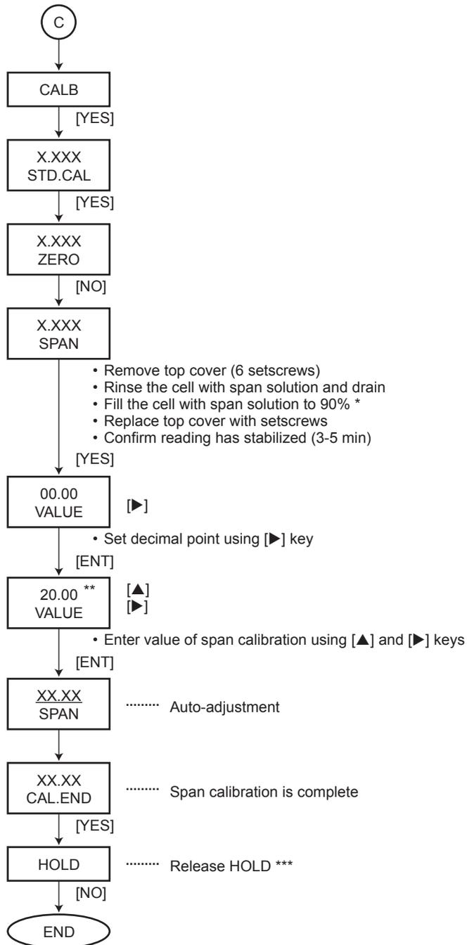
\* How to pour span solution
